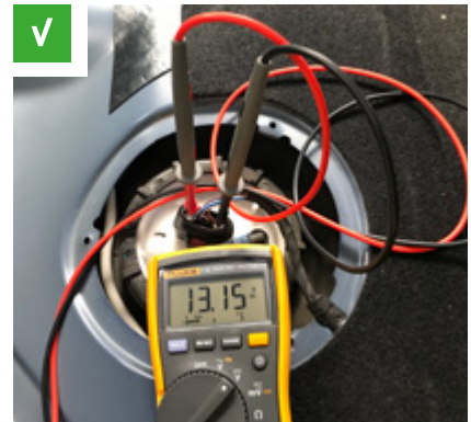
Рис. 2: Электрический разъём на крышке модуля подачи топлива
