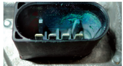
Разъём на корпусе заслонки со следами коррозии
