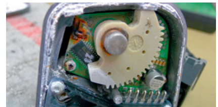
Вид поврежденной регулирующей заслонки изнутри
