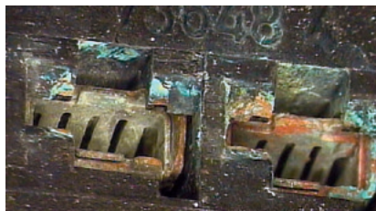
Фрагмент соединительного разъёма со следами влаги и коррозии
