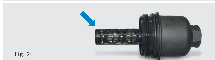
Fig. 1: Tubo de plástico en el cono de cierre del filtro de aceite (MB OM611, OM646, M271). Detalle: cierre de la válvula de drenaje – chaveta cónica con retén
