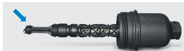
Fig. 1: Tubo de plástico en el cono de cierre del filtro de aceite (MB OM611, OM646, M271). Detalle: cierre de la válvula de drenaje – chaveta cónica con retén
