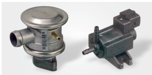
Отсечной обратный клапан с вакуумным управлением (примерно с 1995 г.) и переключающий клапан
