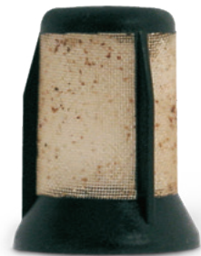
Filtr wstępny E3T – zatkany rdzą
