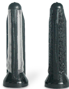
Filtr wstępny E1F: po lewej stronie nowy, po prawej stronie zatkany
