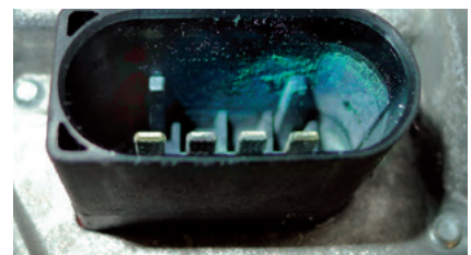
Connettore di montaggio con tracce di corrosione
