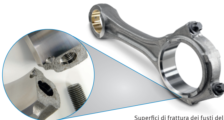
Superfici di frattura dei fusti delle bielle sottoposti a cracking
