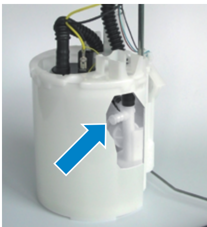
Fig. 1: Vista del módulo de alimentación de combustible (vista vertical) con conector ciego
