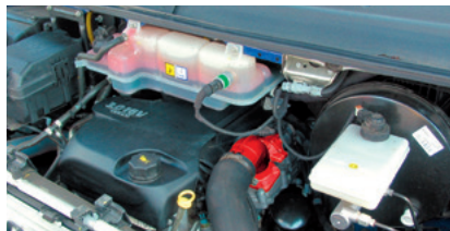
Mariposa de regulación (destacada en rojo) en el compartimento del motor de un Iveco Daily 3.0 l
