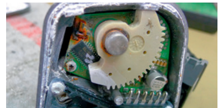
Vista del interior de una mariposa de regulación dañada
