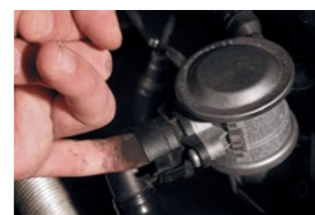
Controllo semplice della valvola aria secondaria
