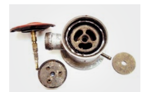
Valvola aria secondaria pneumatica: Danni dovuti alla condensa
