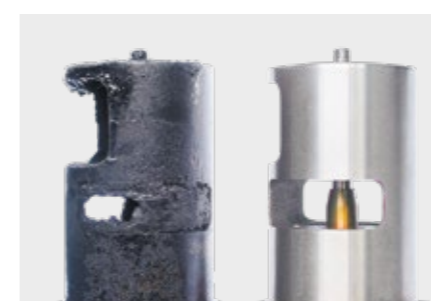
Vanne EGR (diesel) calaminée et à l'état neuf
