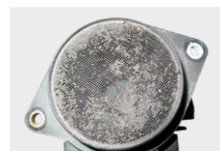
Débitmètre d'air massique (LMS) bouché
