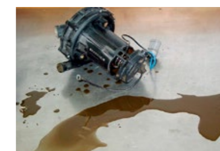
Kondensat in der Sekundärluftpumpe
