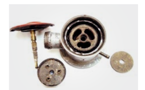
Pneumatisches Sekundärluftventil: Schäden durch Kondensat
