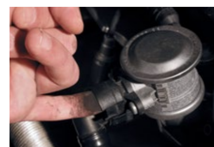
Einfache Prüfung des Sekundärluftventils
