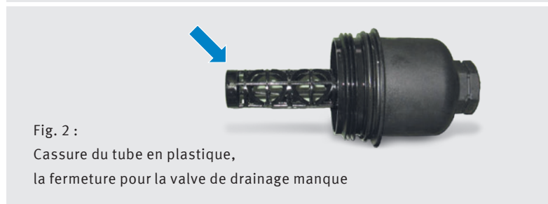
Fig. 1 : Tube en plastique sur le bouchon du filtre à huile (MB OM611, OM646, M271). Détail : fermeture de la valve de drainage – cône avec bague d'étanchéité
