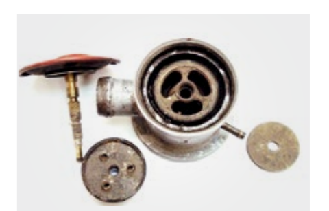
Pneumatyczny zawór powietrza wtórnego: Uszkodzenia spowodowane przez skropliny
