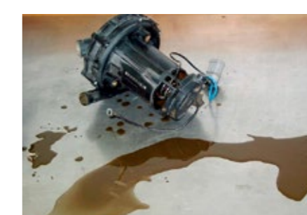
Kondensat w pompie powietrza wtórnego
