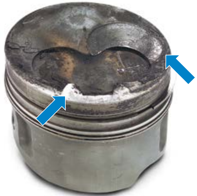
Şek. 4 Motorun aşırı ısınması nedeniyle darbe izleri
