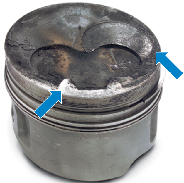
Abb. 4 Anschlagspuren durch motorische Überhitzung
